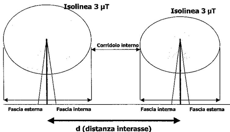
Figura 3: Schematizzazione di un parallelismo tra linee
